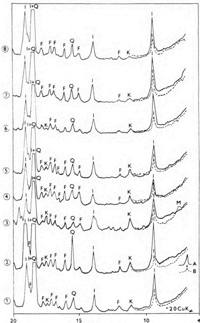
Obr. 4 Röntgendifrakčné záznamy ilovitej frakcie pod 0,002 mm eluviálnych granitových pieskov a štrkov na sv. okraji jadrového pohoria Žiar vo vrte BR-8. 1 — hĺbka 29—30 m; 2 — hĺbka 27—28 m; 3 — hĺbka 23—24 m; 4 — hĺbka 19—20 m; 5 — hĺbka 15—16 m; 6 — hĺbka 11—12 m; 7 — hĺbka 7—8 m; 8 — hĺbka 3—4 m: I — illit; K — kaolinit; Q — kremeň; F — živce. A — vzorka v prirodzenom stave; B — vzorka solvatovaná glycerinom.
